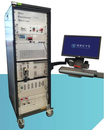
Le Banc Fonctionnel Générique (BFG) permet d'effectuer différents modes de tests sur plusieurs types de produits moyennant un minimum d'adaptation. Il autorise le déroulement d'un ensemble de scénarii qui vont sanctionner la conformité et les performances de l'équipement sous test. Son mode « pas à pas » permet un diagnostic de panne rapide durant les phases de PRODUCTION ou SAV de l'équipement testé. Un autotest et une calibration automatique facilitent sa maintenance périodique.
