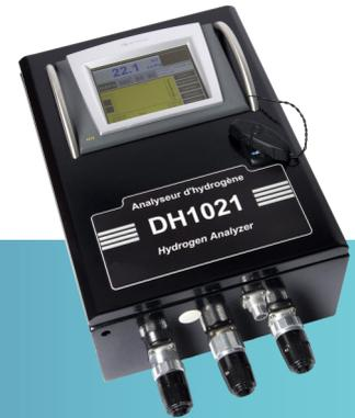
Le DH1021 est un analyseur pour la mesure de la concentration en dihydrogène dissous dans le circuit primaire des REP qui repose sur le principe d'adsorption de l'hydrogène sur le Palladium.
