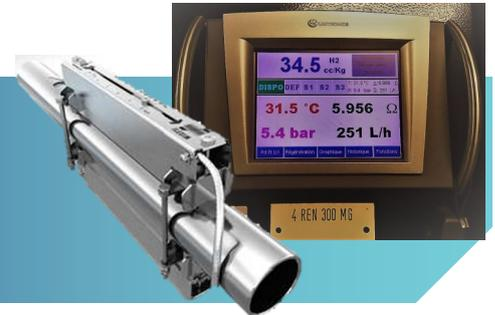
L'ajout de l'option débitmètre non intrusif à l'automate DH1021 permet une lecture en continu du débit dans la ligne d'échantillonnage, une gestion d'alarmes lors de débit non conformes et une protection du capteur H<sub>2</sub> par inhibition de la régénération automatique en cas d'absence de débit.
