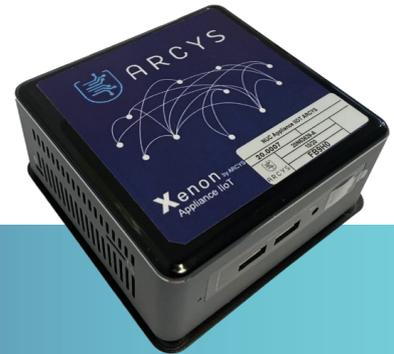
Le XENON est une solution «tout-en-un». Il intègre en un seul produit un Network Server, un Application Server, une zone de stockage et des connecteurs logiciels pour vous interfacier avec vos SI industriels. Elle permet de déployer simplement vos objets communicants sans abonnement. Les données collectées sont alors transmises vers des solutions d'exploitations industrielles, locales ou hébergées.
